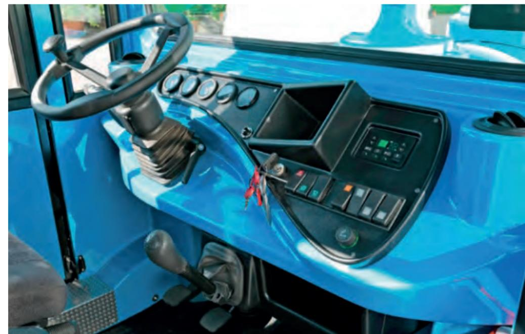
*Un particolare del posto di guida del trenino. La motrice è dotata di cambio, pedaliera e cruscotto del tutto simili a quello delle auto di serie. I vagoni possono essere dotati di accessori per facilitare l'imbarco di disabili su carrozzine.*
